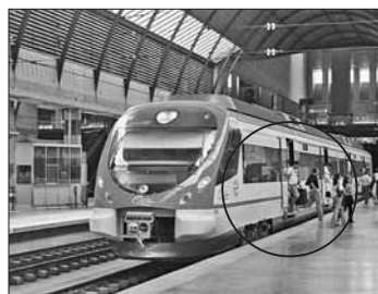
En les quatre fotografies pot observar-se la distància entre l'escaló del tren i l'andana
