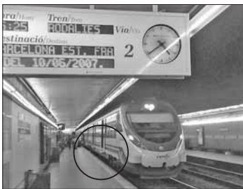
En les quatre fotografies pot observar-se la distància entre l'escaló del tren i l'andana
